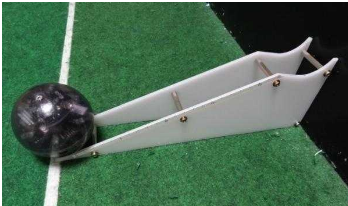
Рис. 1. Устройство для измерения мощности удара
